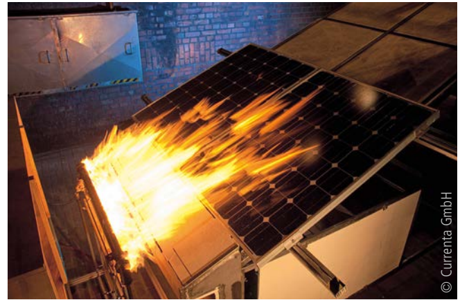
Abb. 14: Prüfverfahren nach IEC 61730-2: Holzrippen für Burning-brand-Test und Durchführung der Spread-of-Flame-Prüfung
