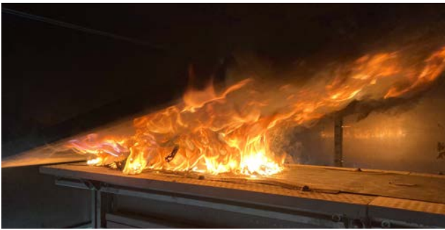
Abb. 1: Rückstrahlung bei einem Brand unter einem simulierten PV Modul – PMMA-Platte simuliert ein brennendes Dach [46]
