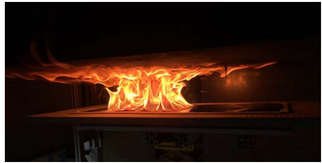
Abb. 1: Rückstrahlung bei einem Brand unter einem simulierten PV Modul – PMMA-Platte simuliert ein brennendes Dach [46]
