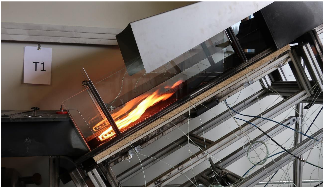
Abb. 2: Versuche nach CEN/TS 1187 (t2) mit simuliertem PV Modul [49]
