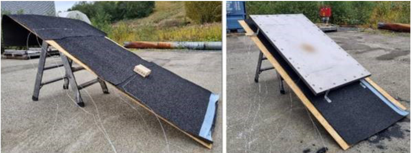
Abb. 3: Versuchsaufbau mittelgroß, Dachbahn unter simuliertem PV Modul, RISE Norwegen [50]
