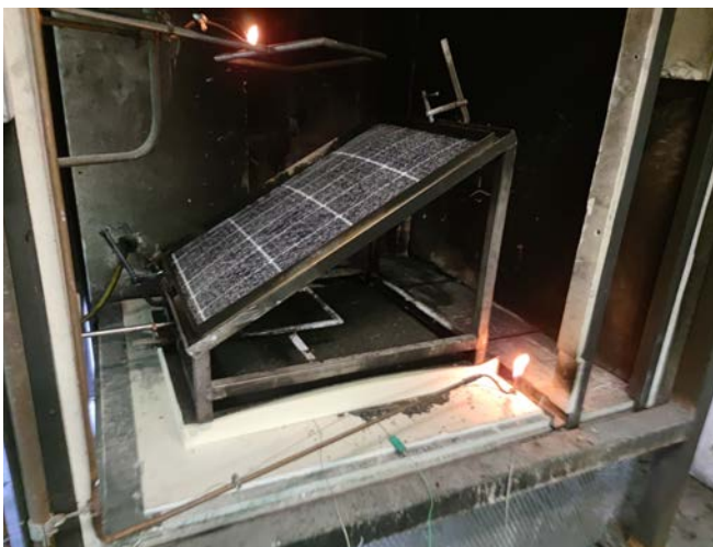
Abb. 8: Prüfung im SBI mit 30-kW-Brenner nach CEI TS 82-89 [71]
