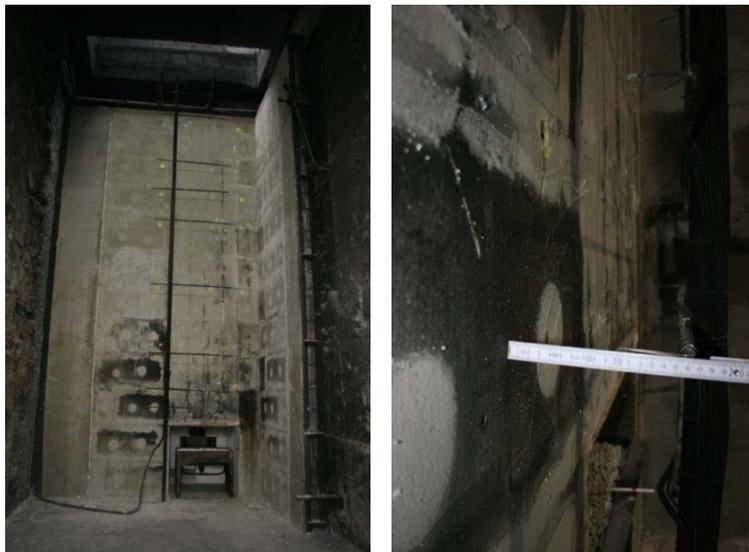
Abbildung 5-6: Ansicht links: Prüfstand unmittelbar vor Ausführung des Kalibrierungsversuchs DIN1 und Ansicht rechts: Messung Abstand 10 cm der Mantelthermoelemente zum Prüfstand [96]
