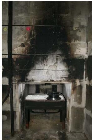
Abbildung 2-12: Darstellung des Gasbrenners mit einem oberhalb abschließenden Kiesbett zur Verteilung der Flamme auf die Grundfläche im skalierten Brandversuch gemäß DIN 4102-20 [32]
