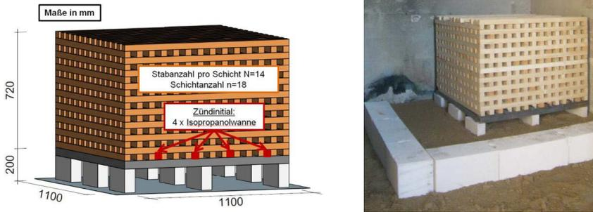
Abbildung 5-29: 200 kg Holzkrippe im Kalibrierungsversuch mit einer zusätzlichen Aufständering auf Mauerwerkssteinen [94]
