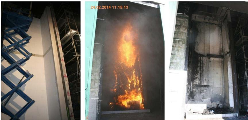
Abbildung 1-1: Sockelbrandversuch an einem WDVS mit EPS (Rohdichte 25 kg/m<sup>3</sup>) und einem Brandriegel auf einer Höhe von 5 m über Oberkante Fußboden. Foto links: Darstellung des applizierten Dämmstoffes mit der Ausführung eines Brandriegels an einem 9,8 m hohem Prüfstand vor Applizierung des Putzes. Foto mitte: Brandgeschehen in der 15. Prüfminute (ca. 10 Minuten Vollbrand der Krippe). Foto rechts: Nach Beendigung des Brandversuchs vollständiger Abbrand der Außenwandbekleidung. [98]
