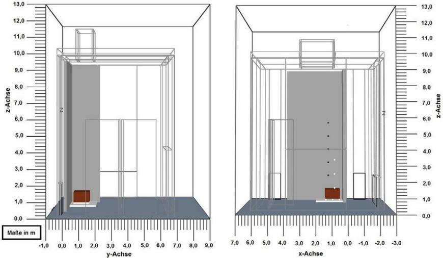
Abbildung 5-40: Geometrische Darstellung der Kalibrierungsversuche Kali1 und Kali2 in FDS mit Berücksichtigung der Prüfhalle
