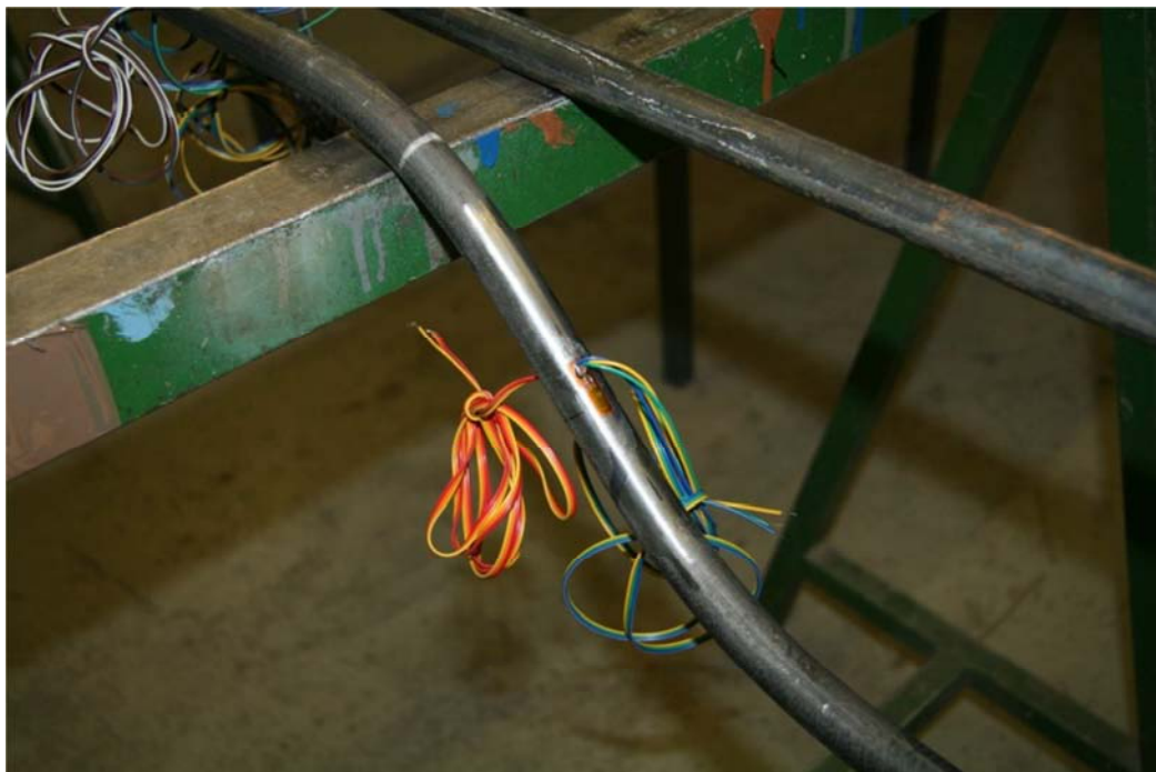
Abb. 5-4: Bewehrung mit Dehnmessstreifen
