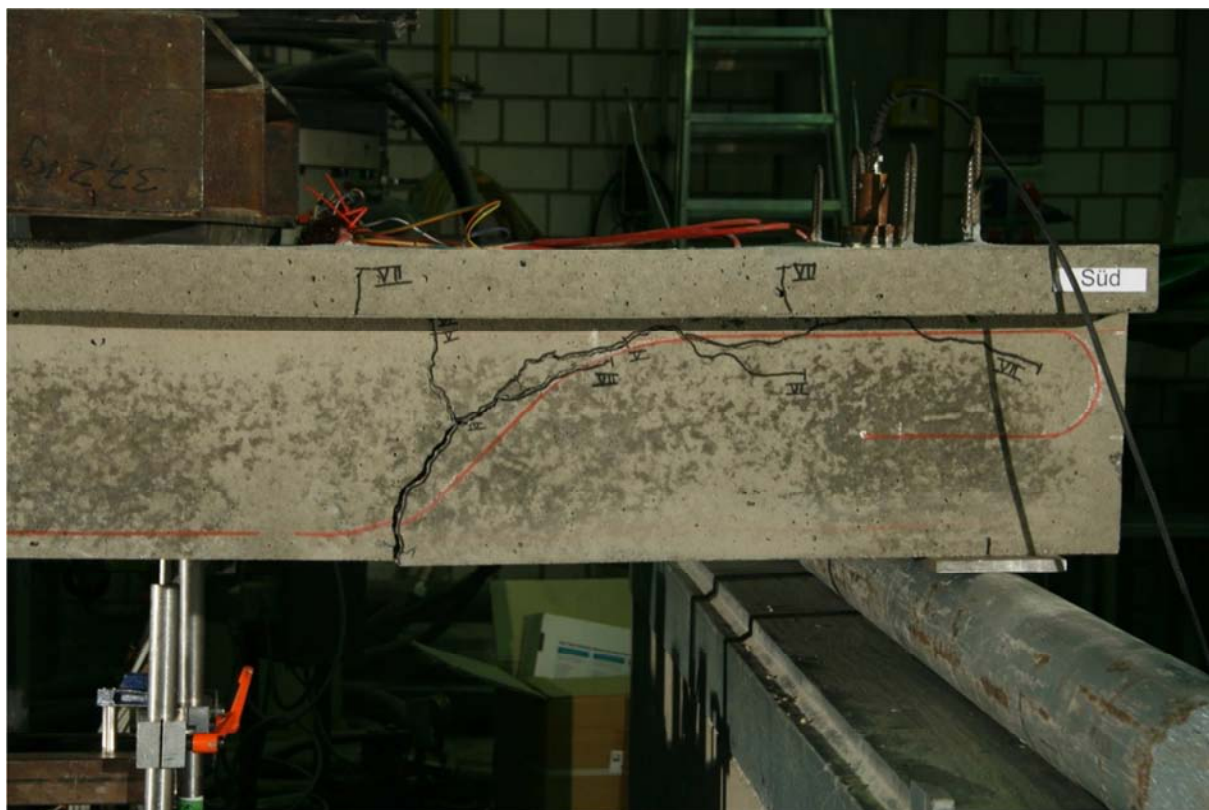
Abb. 7-9: Rippe D Süd, Laststufe 7
