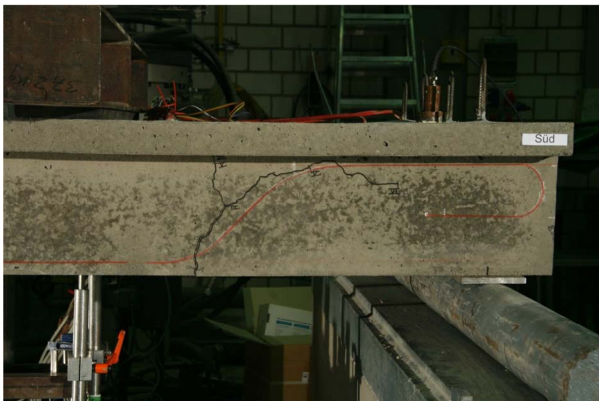
Abb. 7-8: Rippe D Süd, Laststufe 6
