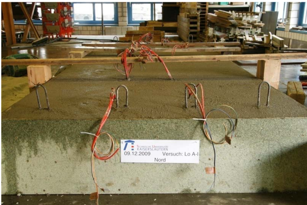
Abb. 5-8: Versuchskörper A-I nach abgeschlossener Betonage
