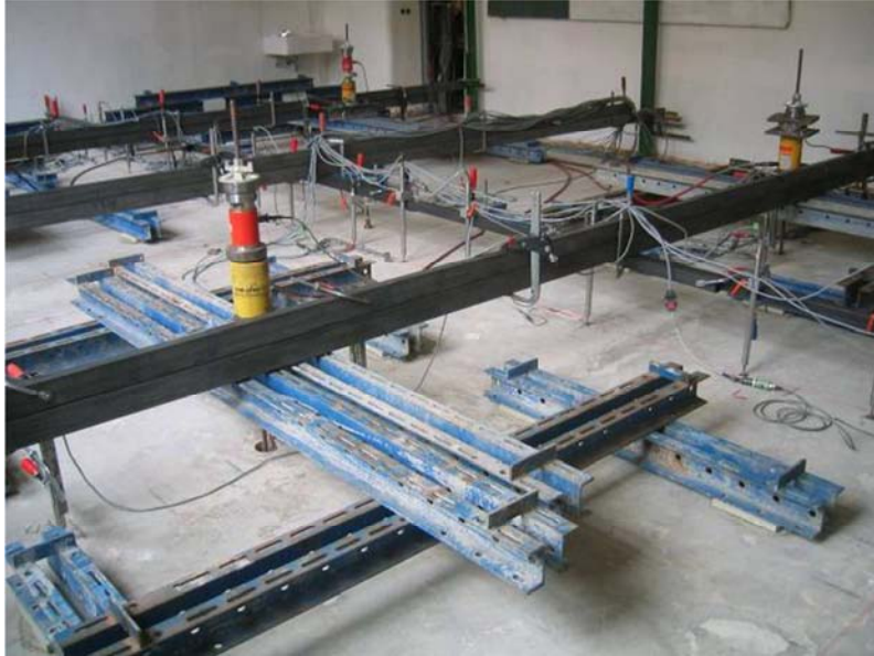
Abb. 3-23: Probelastung einer Hochbaudecke
