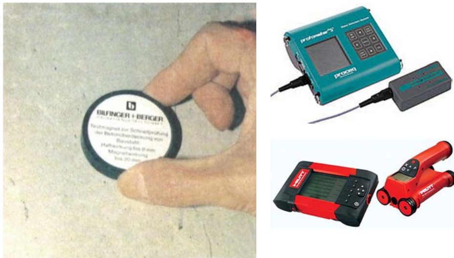
Abb. 3-6: Weiterentwicklung von Betondeckungsmessgeräten
