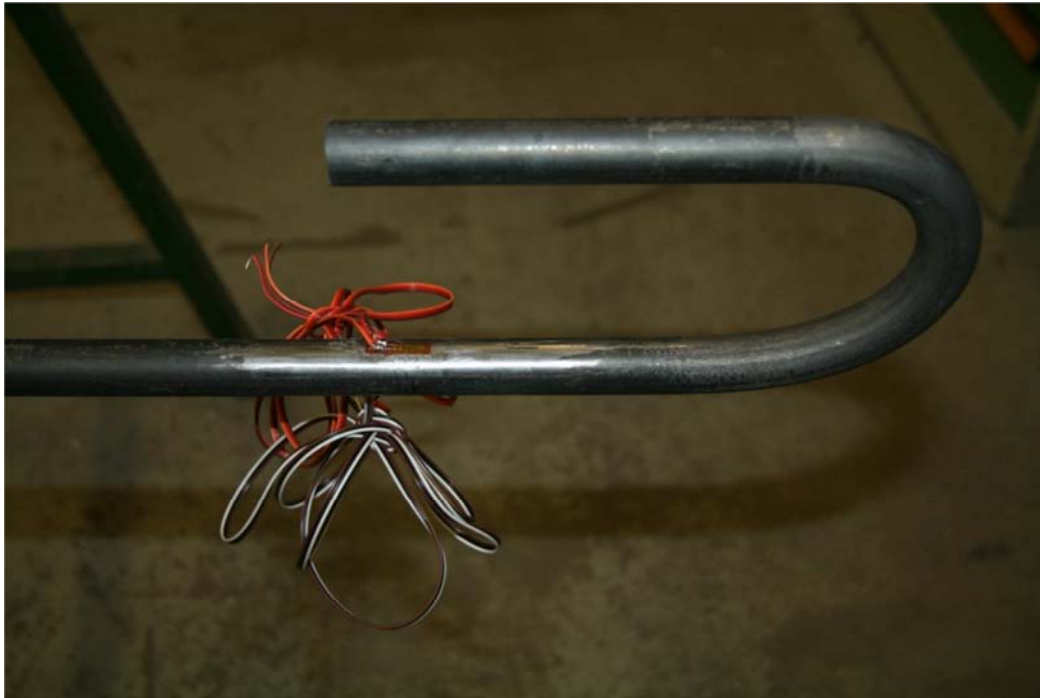
Abb. 5-5: Bewehrung mit Dehnmessstreifen, Detail
