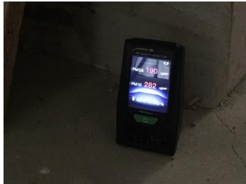
Abbildung 70: Staubmessgerät (positioniert im Flur, während die Schlitzarbeiten ohne Staubschutzwand durchgeführt werden, ausschließlich mit Folie im Zimmereingang (jedoch nicht abgedichtet))
