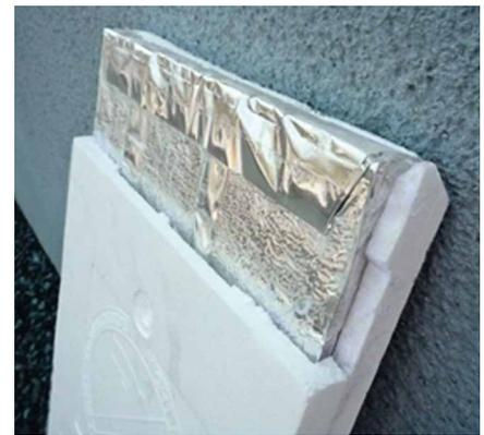
Abb. 5: Die Lösung war eine schlanke Vakuumdämmung. (Foto: Architekturbüro Stocker)
