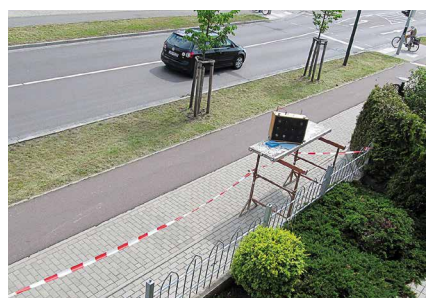
Abb. 9: Messung der Luftschalldämmung eines eingebauten Fensters, Lautsprecherposition
