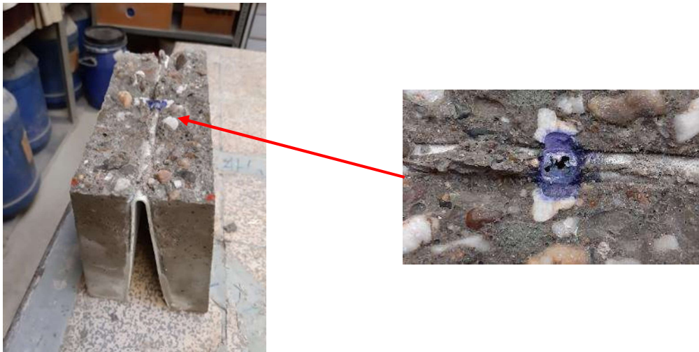
Bild 2.7.1-19. Ergebnis der Hinterlaufprüfung (exemplarisch für eine FBV-Bahn, bei der es keine Unterwanderung mit Wasser gegeben hat)
