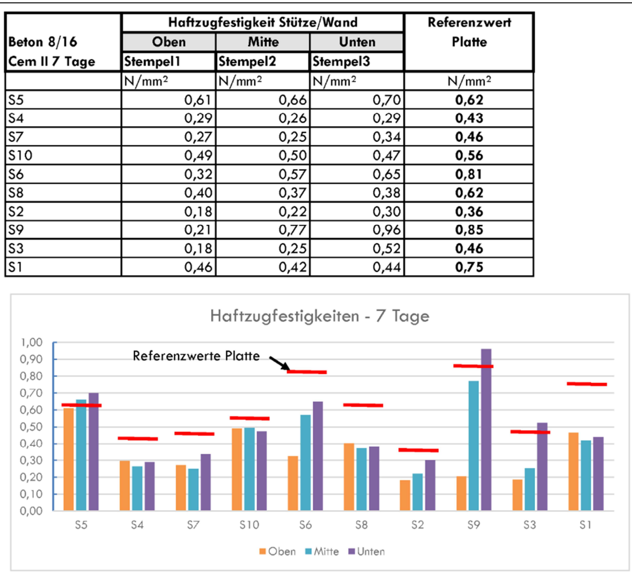
Bild A6-35. Haftzugfestigkeit in Abhängigkeit von der Betonierhöhe – 7 d-Werte – Ergebnisse aus dem Stützen/Wand-Versuch; Probekörperhöhe 2,5 m; Probenahme aus drei Bereichen (Oben (+2,05m bis 2,35 m), Mitte (+1,1 bis 1,4 m) und Unten (+0,15 m bis 0,45 m)); Beton 8/16 Cem II
