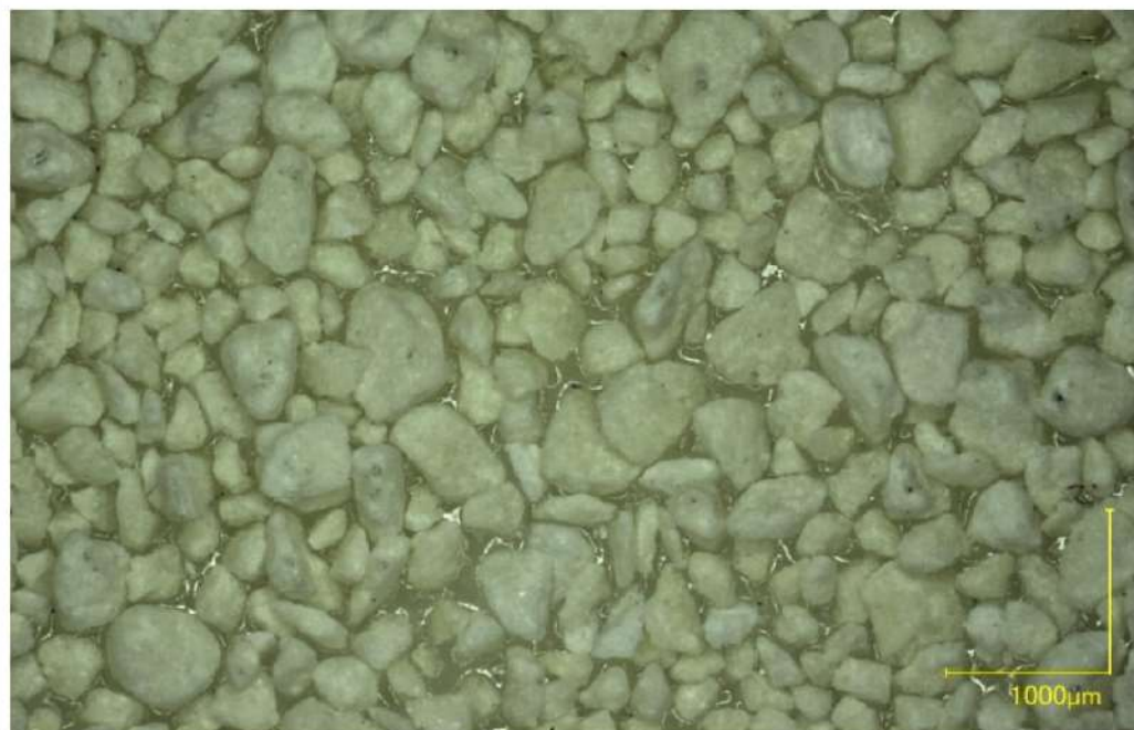
Bild A6-16. Lichtmikroskopische Aufnahme der FBV-Bahn S4 im Anschnitt und der Verbundseite
