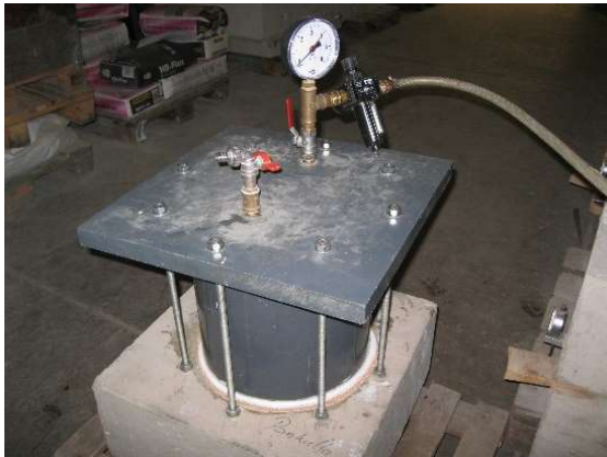
Bild 2.7.2-7. Prüfeinrichtung zur Untersuchung der Wasserdichtheit der T-Stöße der Nähte
