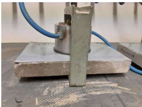
Bild 2.7.1-18. Prüfeinrichtung zur Untersuchung der Hinterläufigkeit der geschädigten FBV-Bahnen
