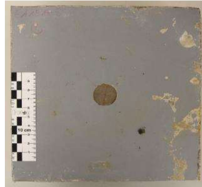
Bild 2.6.2. Probekörper mit appliziertem FBVS vor dem Einbau in die WU-Anlage (Draufsicht auf FBVS)
