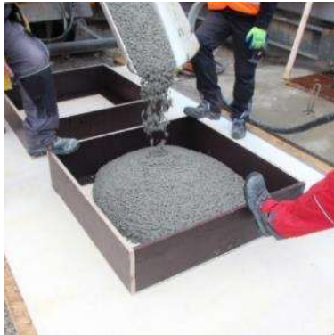
Anlegen von Testfeldern (durch das Baustellenpersonal)
