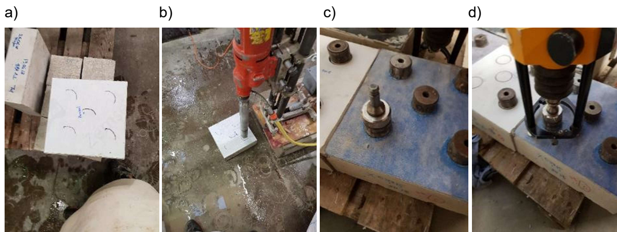
Bild 2.7.1-2. a) Prüfkörper mit markierten Bohrstellen b) Kernbohrung
