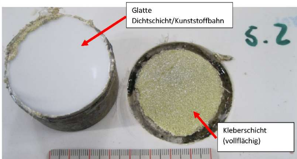
Bild A6-25. Darstellung der Versagensebene der FBV-Bahn S7
