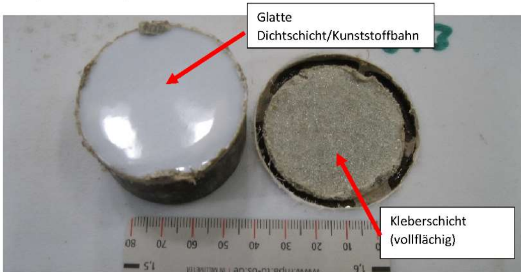
Bild 6-26. Darstellung der Versagensebene der FBV-Bahn S4
