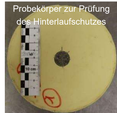
Probekörper zur Prüfung des Hinterlaufschutzes Prüfung der lateralen Wassermigration ( n = 4 , p_{\max} = 5 bar, t = 7 d) sowie der Haftzugfestigkeit ( n = 2 ) nach 28 (bzw. 56) d
