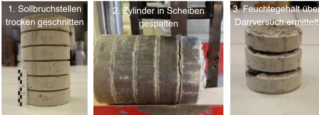
Bild 2.8.14. Vorgehen bei der Bestimmung des Feuchtegehalts über die Probenhöhe
