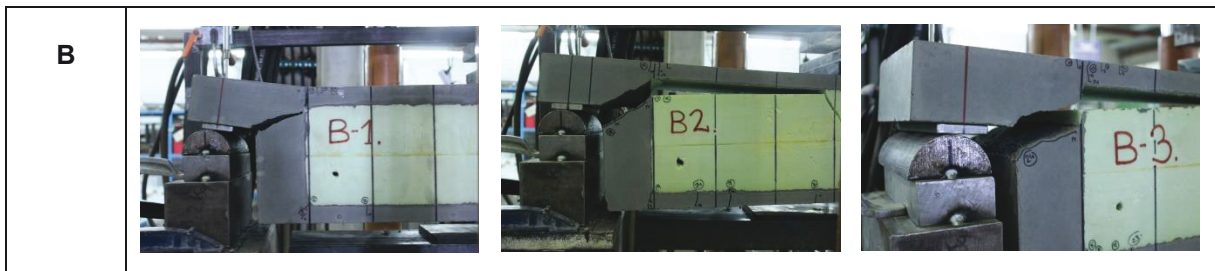
Abbildung 47: Versagensarten der Probekörper B1, B2 und B3
