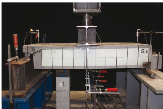
Abbildung 73: Bauteilversagen B, Versagen bei Querschnittsänderung am linken Auflager
