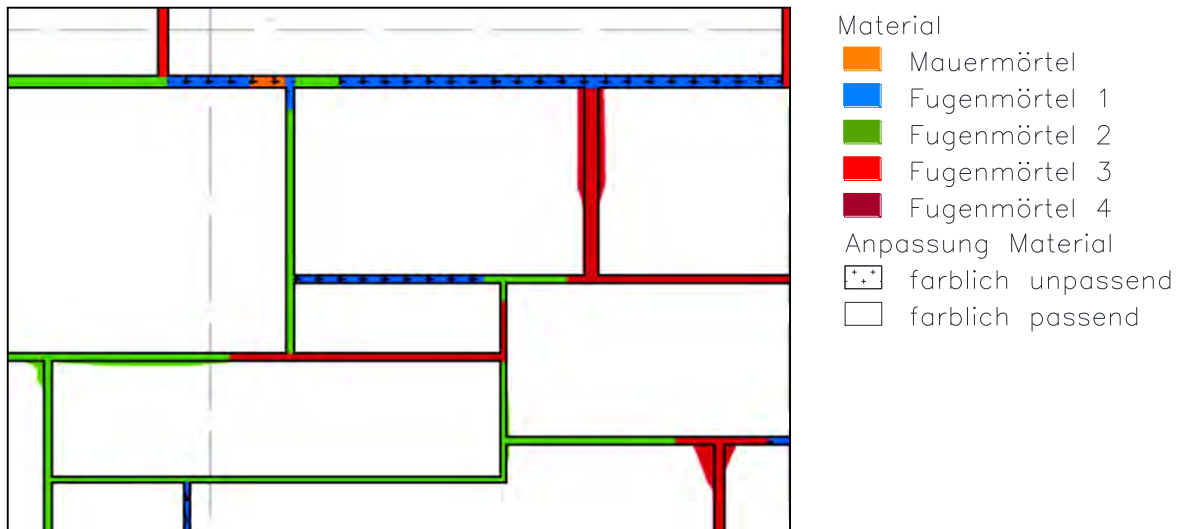
Abb. F1: Ausschnitt einer Fugenkartierung am Alten Schloss/Stuttgart
