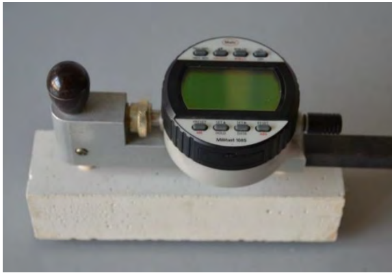
Bild 29: Längenänderungsmessung an aufgeklebten Messmarken mit Messstrecke und Messuhr
