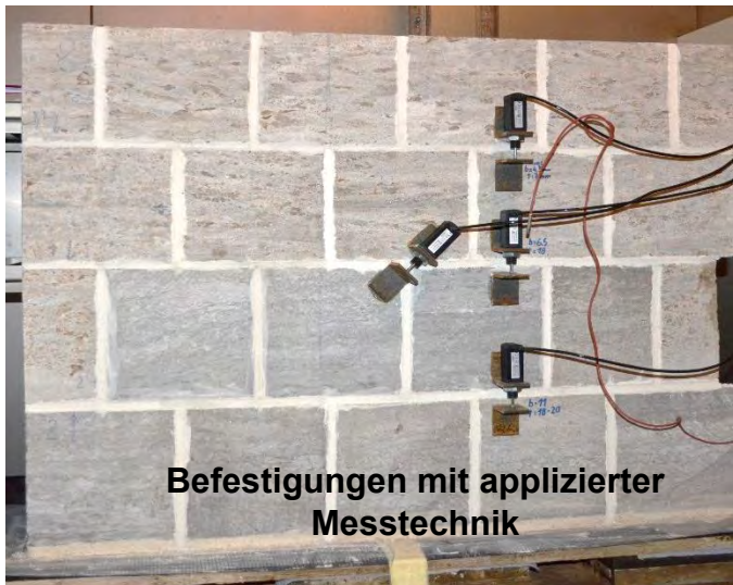
Bild C5: Modellmauer aus Kalkstein (Oberdorlaer und Kirchheimer Muschelkalk) mit Halterungen und induktiven Wegaufnehmern zur Erfassung der thermischen Veränderungen am Natursteinmauerwerk mit Verfugung.
