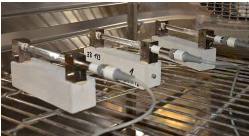
Bild 31: Kontinuierliche Erfassung von Längenänderungen an Mörtelprismen mittels induktiven Wegaufnehmern in einem Klimaschrank
