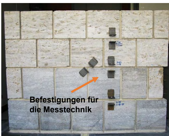
Bild C4: Modellmauer aus Kalkstein (Oberdorlaer und Kirchheimer Muschelkalk) mit Befestigungen für induktive Wegaufnehmer zur Erfassung der thermischen Veränderungen am Natursteinmauerwerk ohne Verfugung. (Die Fugen sind offen.)
