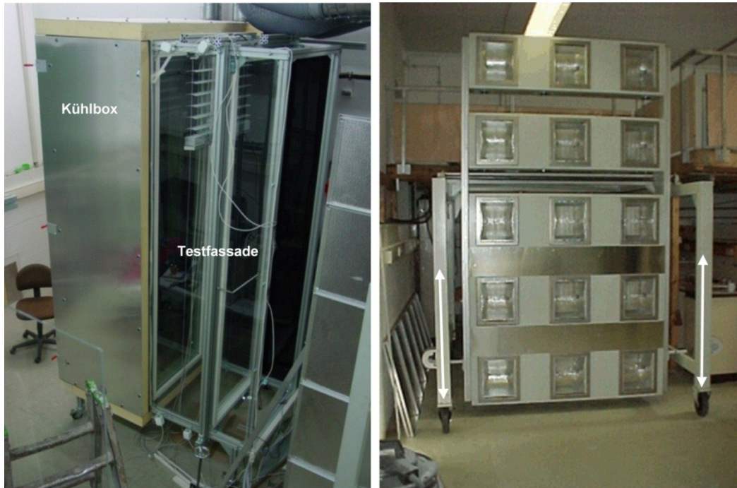
Abbildung 2.11: Testfassade mit Kühlbox (links), Lampenfeld des Sonnensimulators (rechts)
