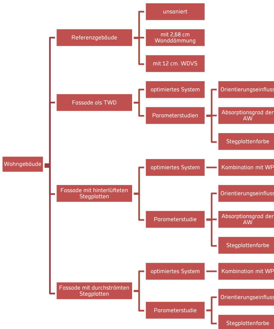
Abbildung 5.6: Übersicht über die untersuchten Varianten des Wohngebäudes
