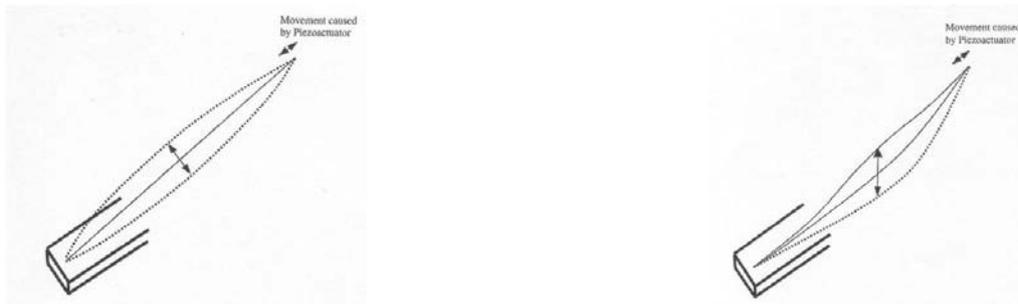
Abbildung 2.9.: Schwingvorgänge an Schrägkabeln (links: quer zur Seilachse; rechts: in Seilachse) nach [SSL06]
