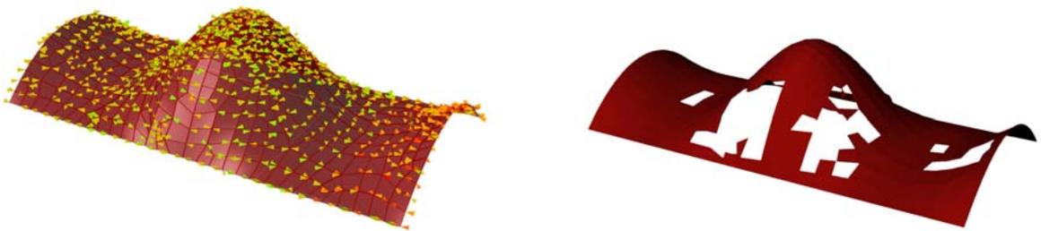
Abbildung 6.46.: DO2 — Hauptspannungen und Topologieoptimierung nach Re-Import
