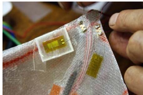
Abbildung 2.16.: Faserverbundstruktur mit Formgedächtnislegierungsstreifen [Evo10]
