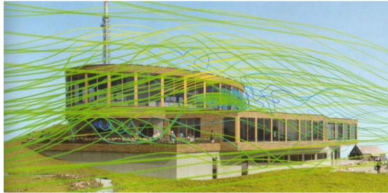
Abbildung 4.7.: Strömungssimulation, [HK10]
