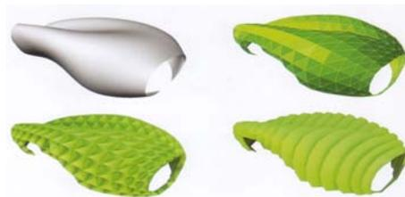
Abbildung 3.38.: Freiformkörper mit unterschiedlichen Oberflächenfaltungen in [Tra09]
