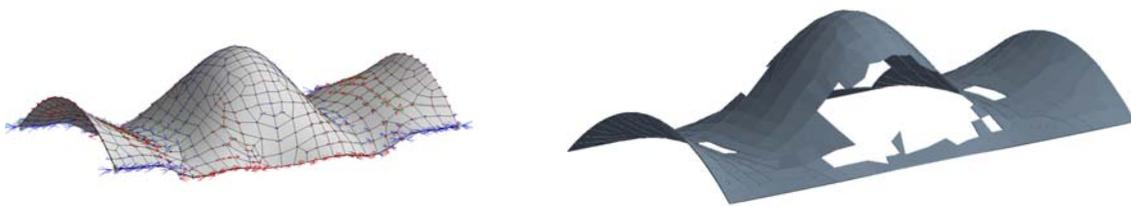
Abbildung 6.44.: DO2 — Hauptspannungen und Topologieoptimierung
