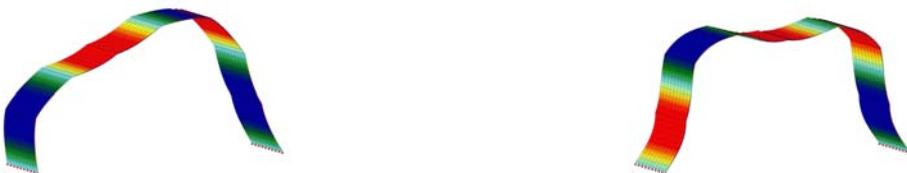
Abbildung 6.16.: DO1 — Darstellung 3. und 4. Eigenfrequenz
