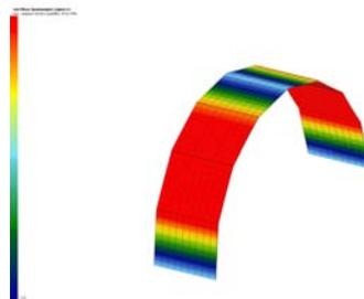
Abbildung 6.29.: DO1 — Spannungsverteilung infolge Windbelastung
