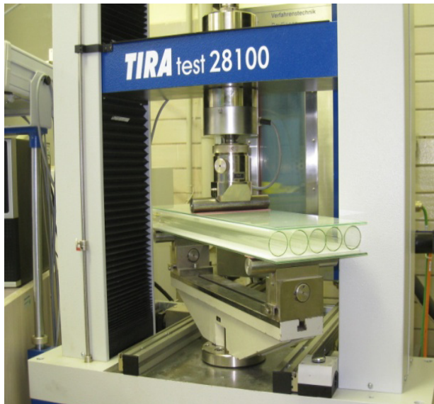
Abb. 4-10 Biegezugprüfung, GKS-Element Variante 1 - Röhren längs
