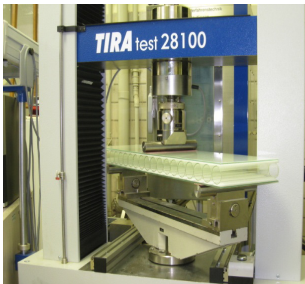
Abb. 4-11 Biegezugprüfung, GKS-Element Variante 2 - Röhren quer
