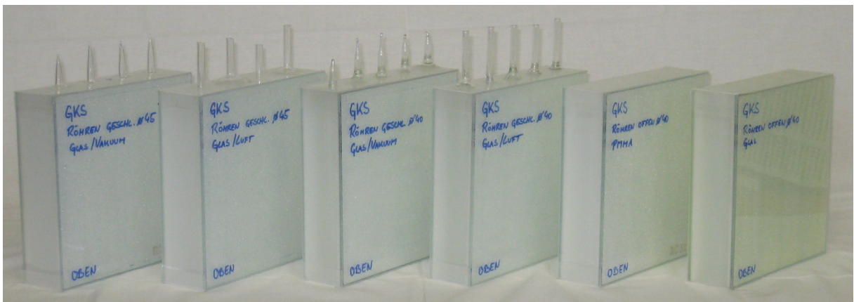
Abb. 4-7 Versuchselemente der Wärmeleitfähigkeitsuntersuchungen (Auswahl)
