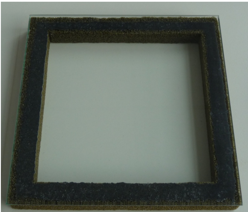
Abb. 6-8 Versuchselement - Glas mit Schaumglasrahmen verlötet [19]
