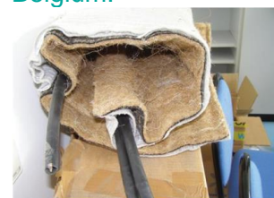
Abb. 1.3: Beispiel eines neuen europäischen WB-Materials. Es ist eine Zusammensetzung aus einer Kokosmatte als Trägerschicht, einem Geovlies zur Wasserspeicherung und der gleichmäßigen Wasserverteilung, sowie einem weiteren, stabilen Trägervlieses, in das die Tropfschläuche eingelassen sind. EAME Huntsman-Polyurethanes EBDT Commercial Everslaan 45 B-3078 Everberg – Belgium.
