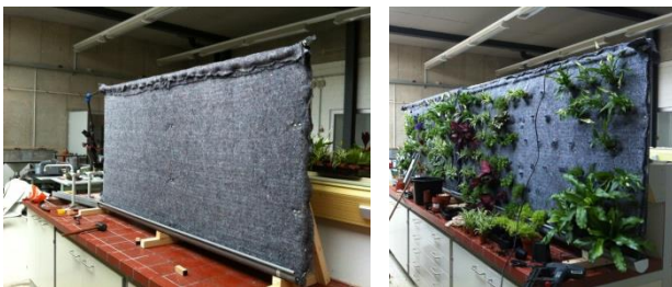
Eine vorbereitete PVC-Platte mit Geovlies, April 2012 und kurz nach Bepflanzung
